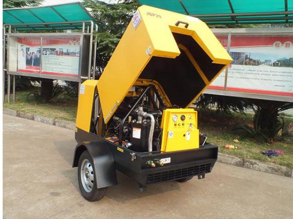
Дизельные передвижные винтовые компрессоры, как и их стационарные собратья, отличаются производительностью и способом получения сжатого воздуха.
