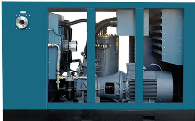
Особенности: двухступенчатый винтовой блок серии SKY 2 запатентован, спроектирован на максимальное давление 40 бар, двухступенчатое сжатие, SKF подшипники, прямой привод, отсутствие шума шестерен, оптимальная конструкция, возможность работы на двух режимах.
