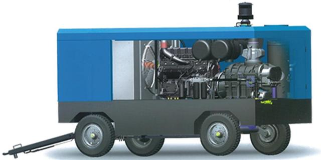
Особенности: двухступенчатый винтовой блок серии SKY 2 запатентован, спроектирован на максимальное давление 40 бар, двухступенчатое сжатие, SKF подшипники, прямой привод, отсутствие шума шестерен, оптимальная конструкция, возможность работы на двух режимах.
